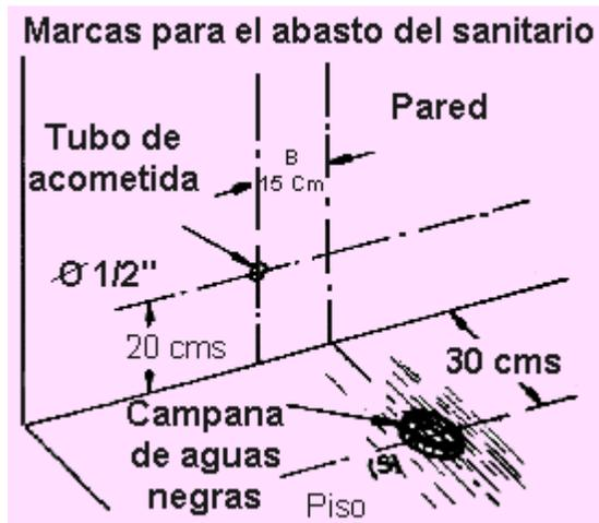
**c. Marcar puntos terminales y trazar**
